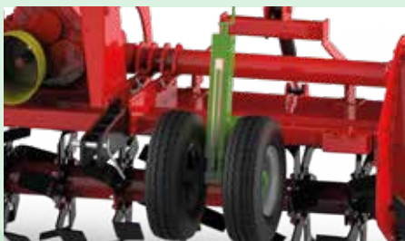
Ruote gemellari anteriori regolabili. Frontal tread adjustable twin wheels. Ruedas de apoyo delanteras regulables continuamente.
