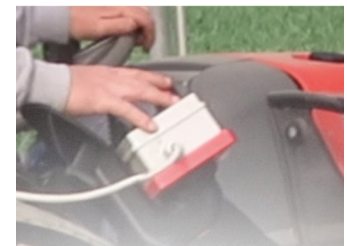
Console di comando in posizione comoda all'operatore, gestisce tutte le funzioni operative della macchina.
