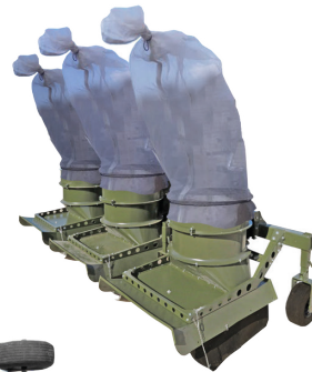
Rete di contenimento che evita la dispersione dei residui di lavorazione, quali insetti e foglie secche.
