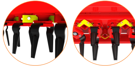
Stone guards with W尔多x screwed plates Rotorschutz mit verschraubten W尔多xkeilen Protections rotors avec plaquettes en W尔多x boulonnées
